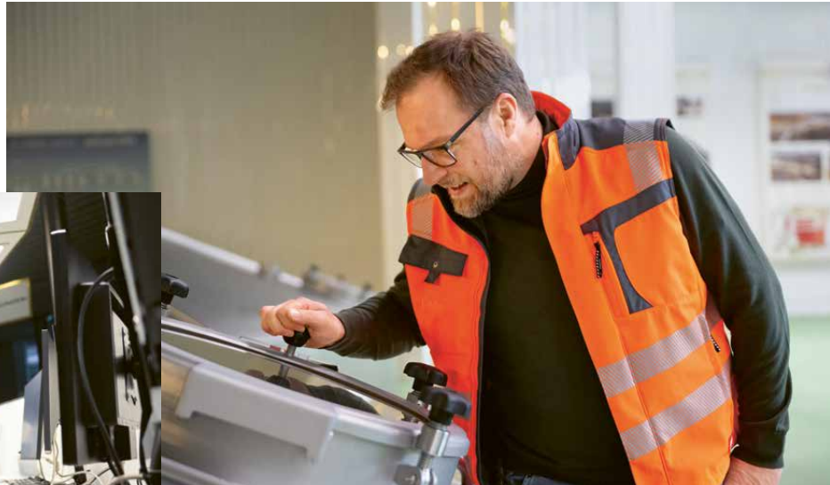
Beim Maischen wird das geschrotete Malz in riesigen Behältern mit Wasser gemischt und erhitzt.
