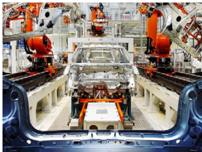
Aus rund 390 Teilen wird die Karosserie eines A3 zusammengeschweißt. Mit 98 Prozent ist der Automatisierungsgrad im Karosseriebau so hoch wie in keinem anderen Produktionsschritt.
