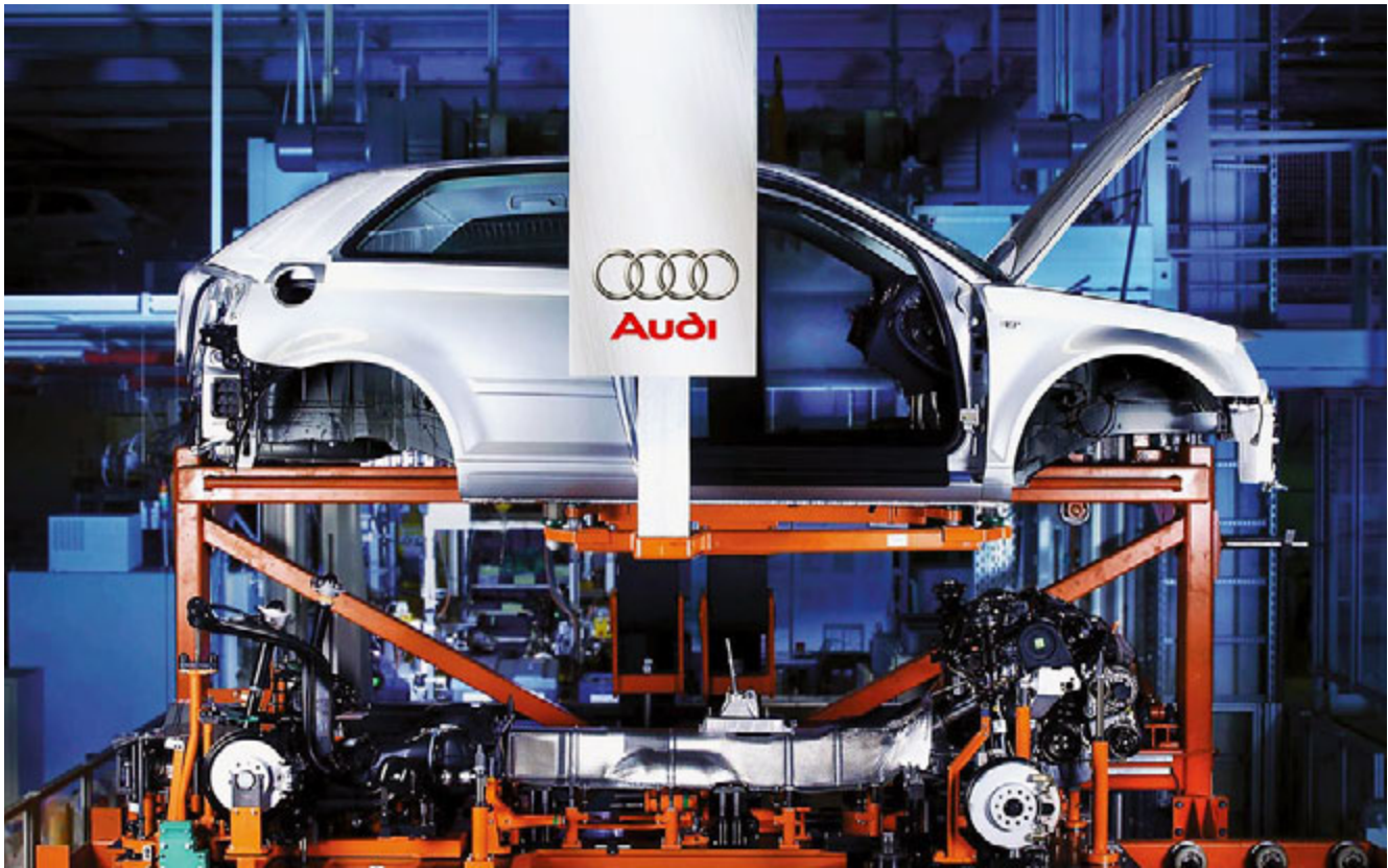
Fast alle zwei Minuten wird in der Endmontage „Hochzeit gefeiert“. Bei diesem Produktionsschritt wird die Karosserie mit der Antriebsplattform zusammengefügt.
