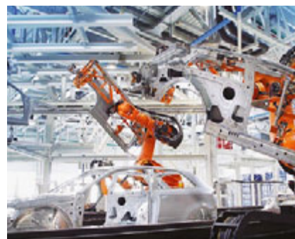
Nach dem Prinzip bringen, positionieren und verbinden bewegen sich die Handling-Roboter mit fertigen Seitenteilen um die Karosserie herum und setzen sie zusammen.
