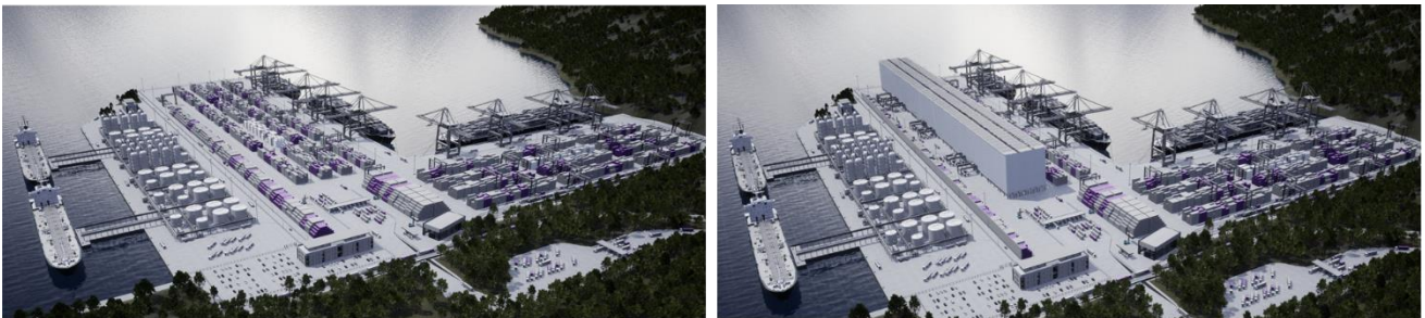
Abb. 16: Steigerung der Jahreskapazität eines RTG-Terminals durch einen Teilumbau auf BOXBAY
