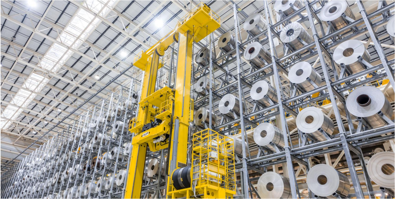
Abb. 3: Hochregallager für Aluminium-Coils
