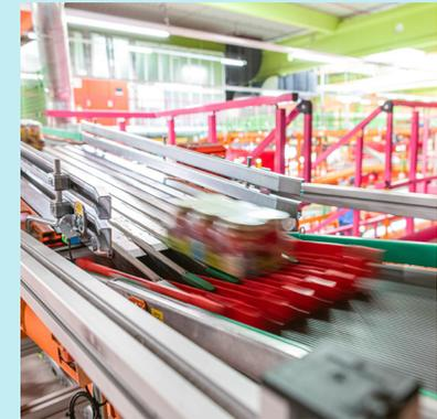
237.000 speziell entwickelte Trays ermöglichen bei hohen Geschwindigkeiten das sichere Be- und Entladen mehrerer tausend verschiedener Artikel.
