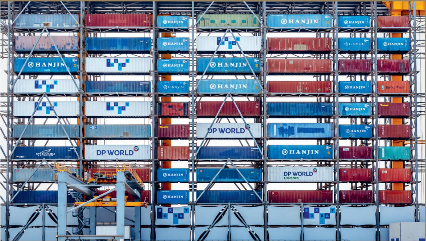
Jeder Container lagert in einem eigenen Fach, sodass er jederzeit zugänglich ist und ein- oder ausgestapelt werden kann.
