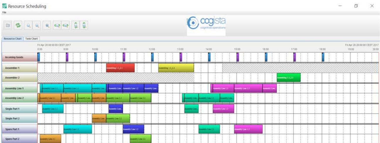
Die Plantafel ermöglicht dem Planer per Mausklick Ressourcen in einem Prozessablauf zu verschieben und die Auswirkungen sofort zu verstehen.
