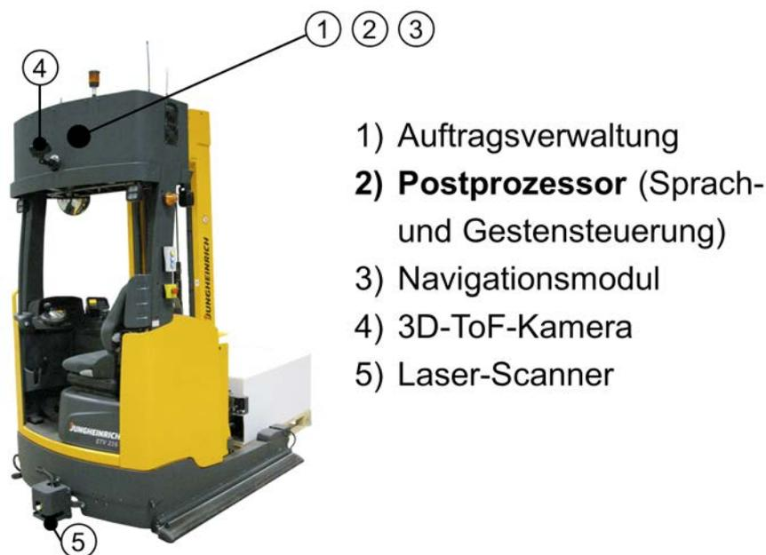
Abbildung 3: Komponenten am Gabelhub-FTF mit integrierter Sprachsteuerung
