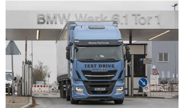
Eine Alternative zu BE-LKW sind Erdgas-LKW, welche sich durch eine Reichweite von bis zu 1.600 km auszeichnen. Neben 25 Prozent CO<sub>2</sub>-Reduktion gegenüber herkömmlichen Diesel-LKW, zeichnen sich diese Modelle ebenfalls durch eine wesentliche Lärmreduktion aus. Eingesetzt werden sie bereits für die Versorgung des BMW Werkes Leipzig. Ein vielversprechender Pilotbetrieb eines LNG LKW zwischen Regensburg und Steyr wurde im Februar dieses Jahres erfolgreich abgeschlossen.
