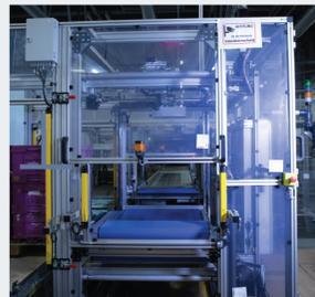
Die nächste Generation des SplitBots konnte durch das neue, zuverlässige Sicherheitskonzept als Pilot im Werk Leipzig eingesetzt werden. Für diesen Entwicklungsstand wurde eine stabile Rotation der Behälter, sowie eine niedrigere Prozesszeit und höhere Robustheit umgesetzt. Zusätzlich hat dieser Stand des SplitBots die CE-Zertifizierung erhalten.
