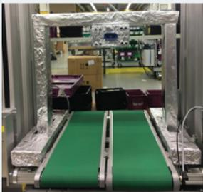
Beim sogenannten Proof of Technology (PoT) wurde im ersten Schritt die reine Technologie ohne einen konkreten Prozess untersucht. Dabei wurde festgestellt, dass die Kamera in Kombination mit Künstlicher Intelligenz in der Lage ist, die Behälter zu erkennen.
