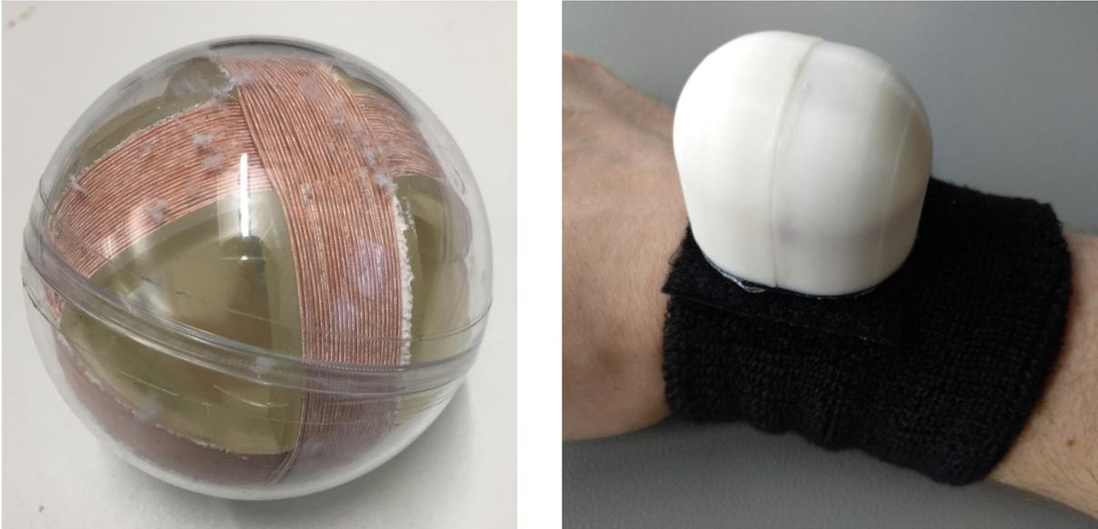
Abbildung 56: Dreidimensionale Spule in Entwicklungszustand links und integriert auf dem Kommissionierarmband rechts
