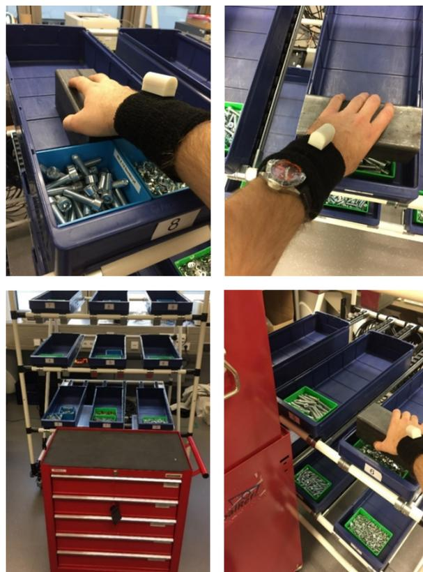
Abbildung 34: Entnahme eines großen Stahlteils bei mit Schrauben befülltem Regal (oben links), zusätzlich mit metallischer Armbanduhr (oben rechts), zusätzlich mit Werkzeugkasten vor dem Regal (unten links und rechts)
