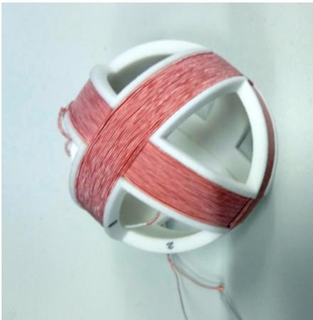
Abbildung 21 3D Sekundärspule
