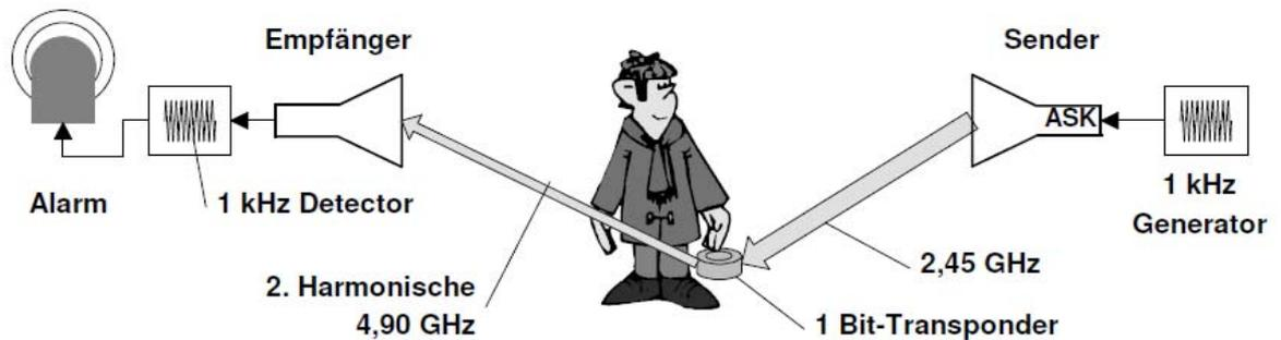
Abbildung A3.3: Mikrowellen-Etikett im Ansprechbereich eines Detektors, nach /FINK/, S.37
