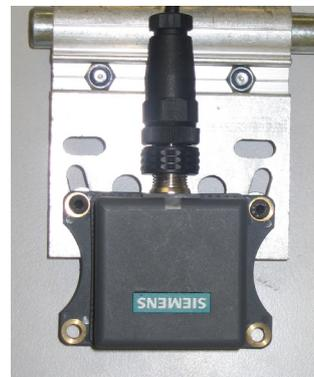
**Abbildung 21: UHF-Nahfeldantenne**
