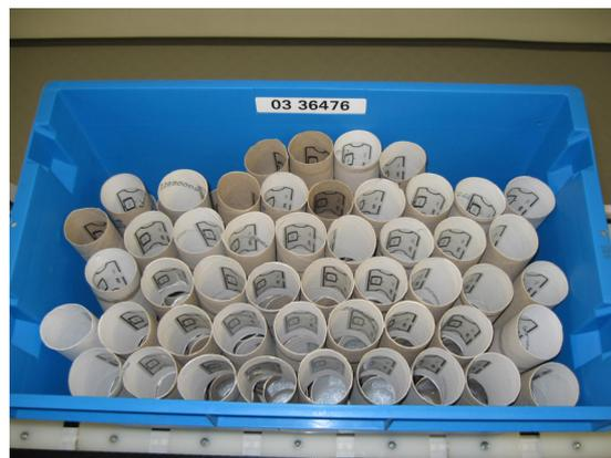
**Abbildung 30: Bestimmung der maximalen Anzahl identifizierbarer Transponder**
