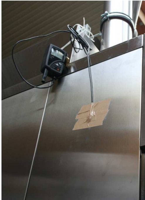
Abbildung 7: Thermohygrograf zu Langzeitmessung von Oberflächen- sowie Lufttemperatur an einem Ofen in einem Fertigungsbereich
