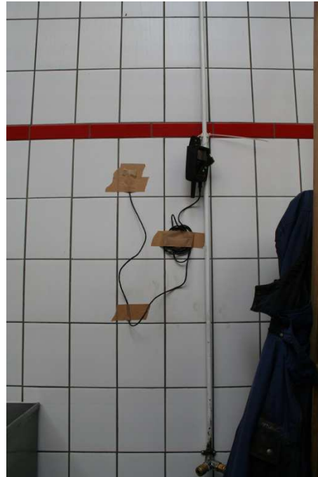
Abbildung 8: Thermohygrograf an einer Innenwand in einem Fertigungsbereich
