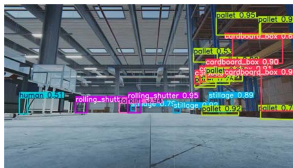
Abbildung 34: Beispielergebnis der Objektdetektion; Bounding-Boxen in verschiedenen Farben für verschiedene Objekte (bspw. Rolltore in lila)
