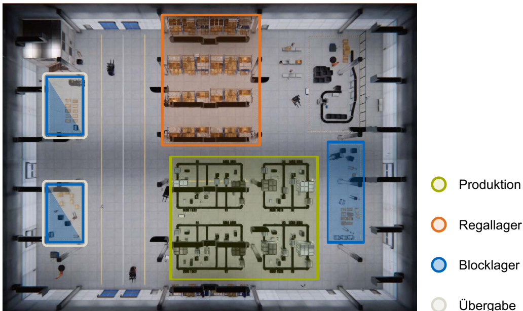
Abbildung 12: Hallenlayout aufgebaut aus den Zonen: Produktion, Regallager, Blocklager und Übergabe von Wareneingang zur Lagerung
