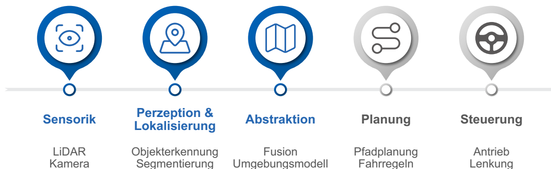
Abbildung 4: Fünf Bestandteile für autonome Fahrfunktionen nach [6]; Planung und Steuerung werden nicht im Projekt betrachtet
