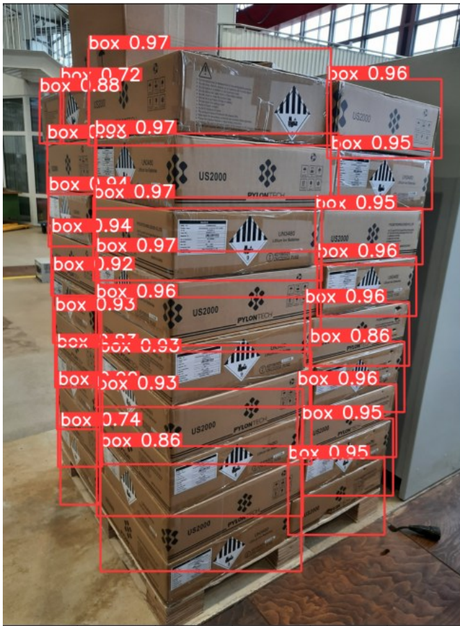
Abbildung 10: Paketerkennung über YOLOv8.
