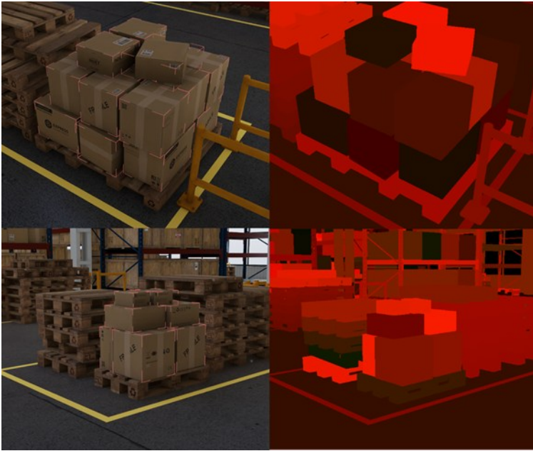
Abbildung 3: Nvidia Omniverse: Links: erste Paletten mit Zuladung. Rechts: Objekte nach ID eingefärbt.
