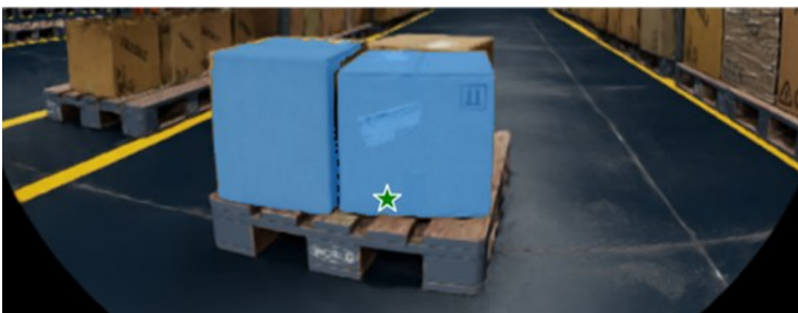
Abbildung 9: Ladungssegmentierung über SAM. Der Stern repräsentiert die Mitte der Palette, was als Start für die Segmentierungsmaske verwendet wird. Die abschließende Segmentierungsmaske wurde über die blaue Einfärbung visualisiert.
