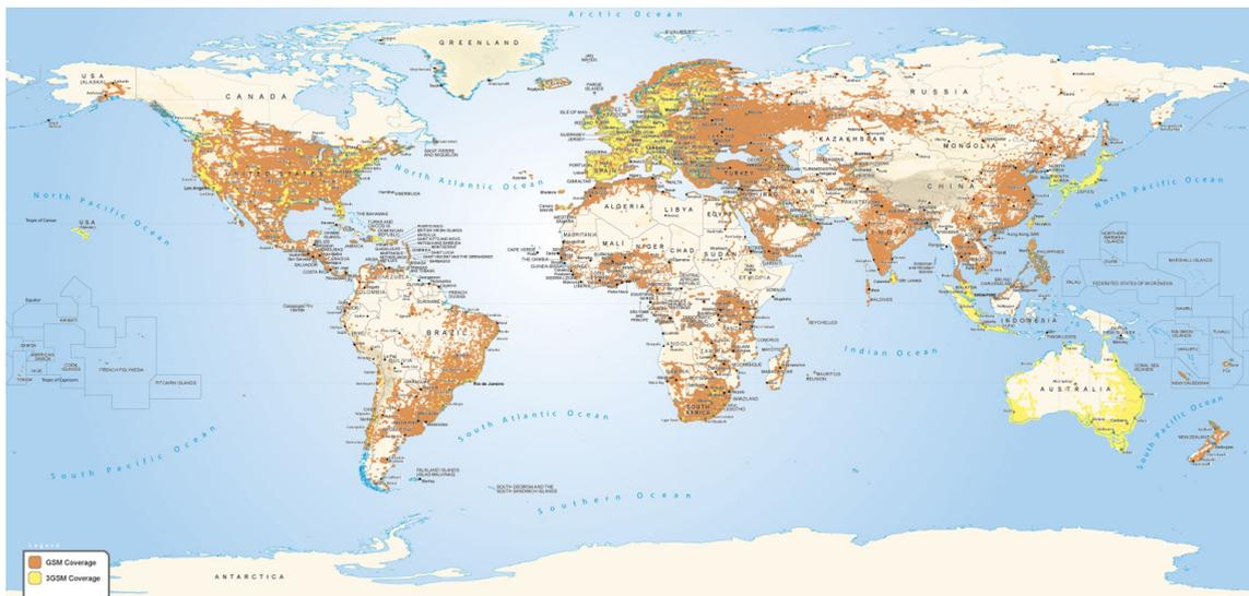
**Abb. 6.23: Weltweite GSM-Netzabdeckung [Kam11]**
