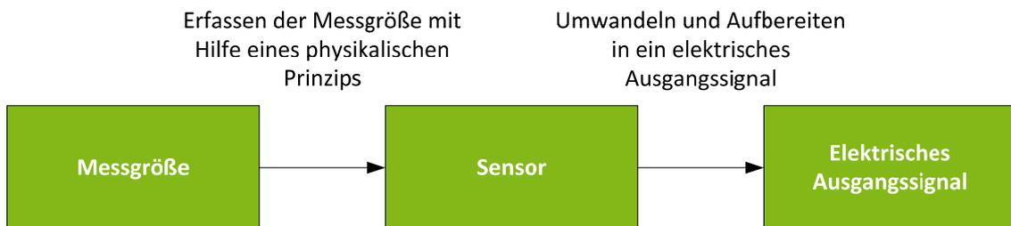
Abb. 6.2: Arbeitsprinzip Sensor [Moc11]
