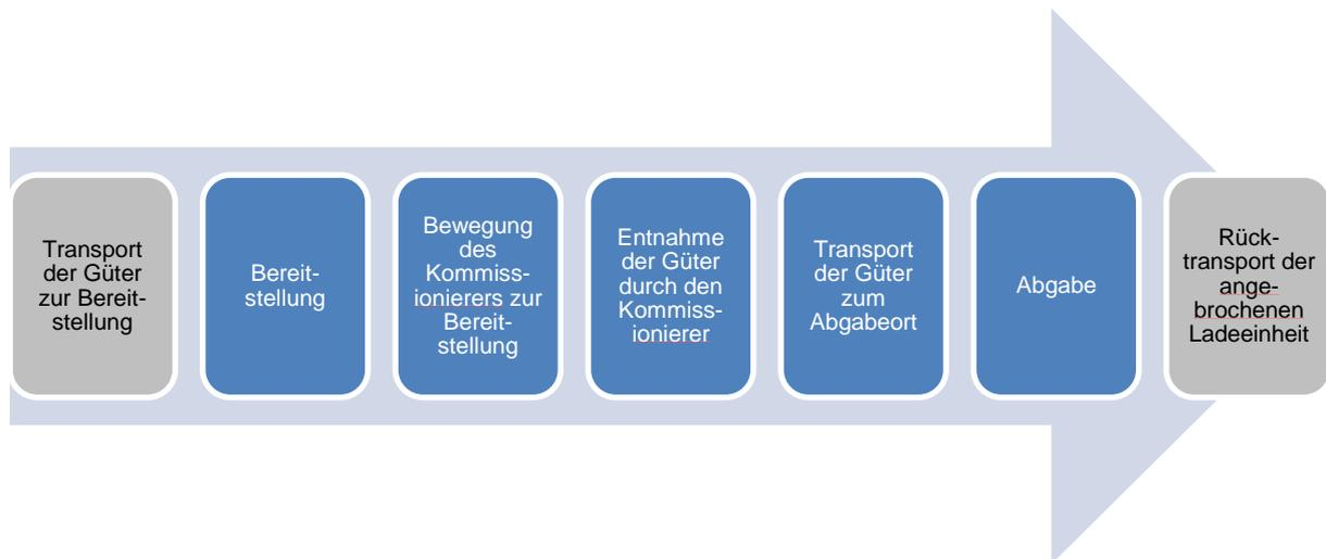
**Abbildung 2: Vorgänge im Materialflusssystem<sup>44</sup>**
