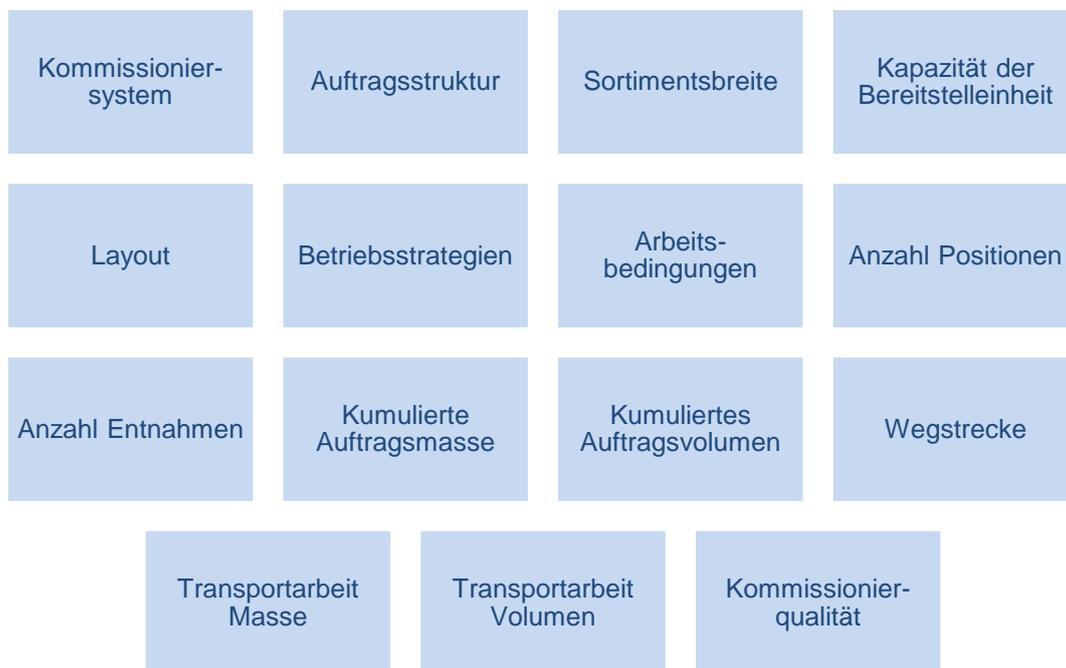
Abbildung 4: Einflussfaktoren auf die Kommissionierleistung<sup>72</sup>
