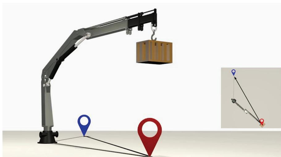
Abbildung 4-8: Screenshot aus einem der Animationsvideos. Konkret wird Bewegung 3 aus Position 4 dargestellt (vgl. Abbildung 4-7). Von der Startposition (roter Marker) sollte die Last ca. in einem 120 deg Winkel zur Zielposition (blauer Marker) bewegt werden. Unterstützend werden ein Pfeil am Boden sowie die Vogelperspektive der Bewegung gleichzeitig animiert angezeigt.
