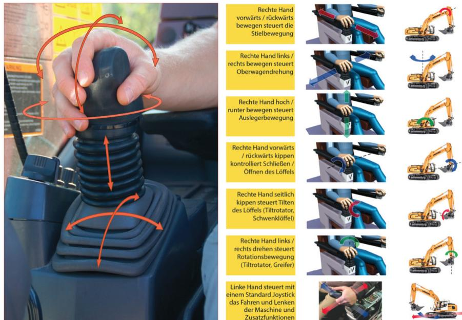
Abbildung 2-8: uniGRIP System mit 6 Freiheitsgraden [Vem-2019b]
