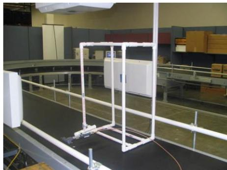
Abbildung 6-8: Exemplarische Vorrichtung zur Positionierung der Messantenne nach [EPC-09b]
