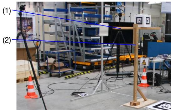
Abbildung 6-5: Vorrichtung zur Antennenpositionierung: (1) Querbalken zur horizontalen Positionierung, (2) Höhenverstellung
