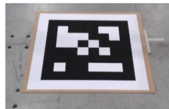
Abbildung 2-14: Flachmarker im Kamerabild
