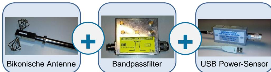
Abbildung 4-25: Komponenten der Feldstärkemessung
