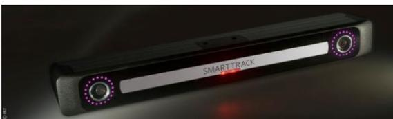
Abbildung 4-2: IR Tracking-System mit Stereokameraansatz [ART-2014c]
