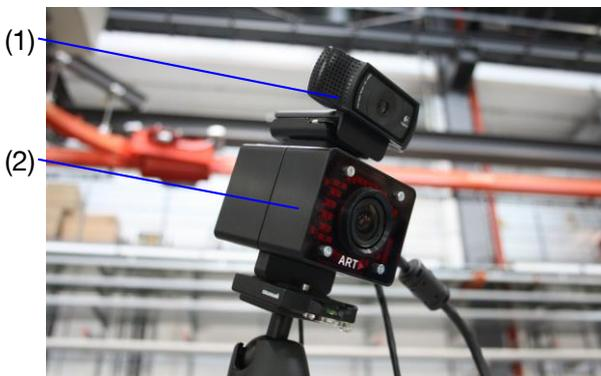
Abbildung 6-3: Parallelinstallation der Kameras: (1) USB-Kamera, (2) ART-Trackingkamera
