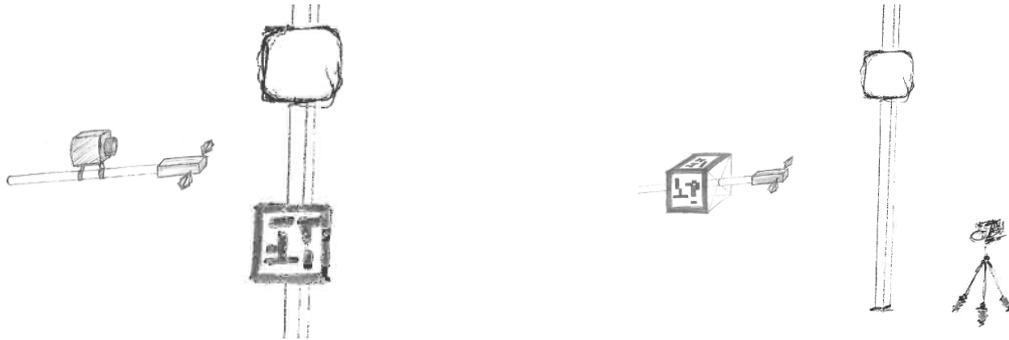
Abbildung 4-18: Skizze zum Inside-Out-Ansatz zur Erfassung der Messantennenpose
