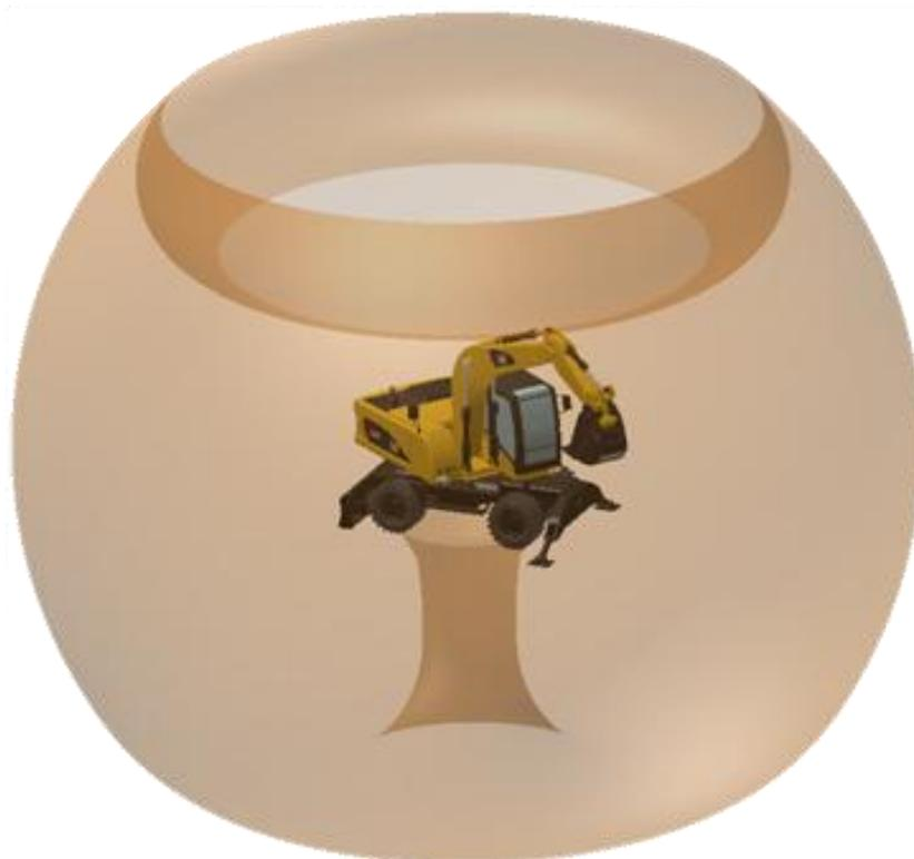
Abbildung 6-16: 3D-Objekt mit Hüllkurve (Caterpillar Bagger M318)
