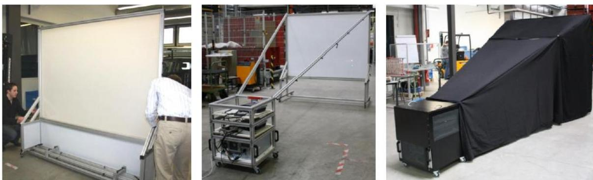
**Abbildung 5-6: mobile VR-Wand, Leinwand, Gerüst und Gesamtsystem [Kam-2011]**
