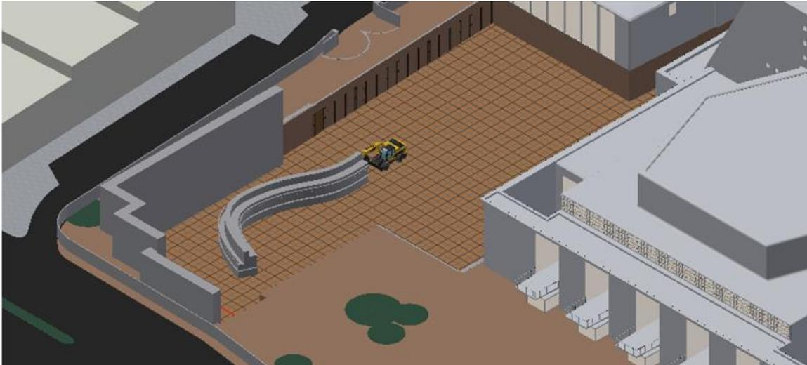
Abbildung 6-15: Kollisionskontrolle entlang einer Fahrstrecke
