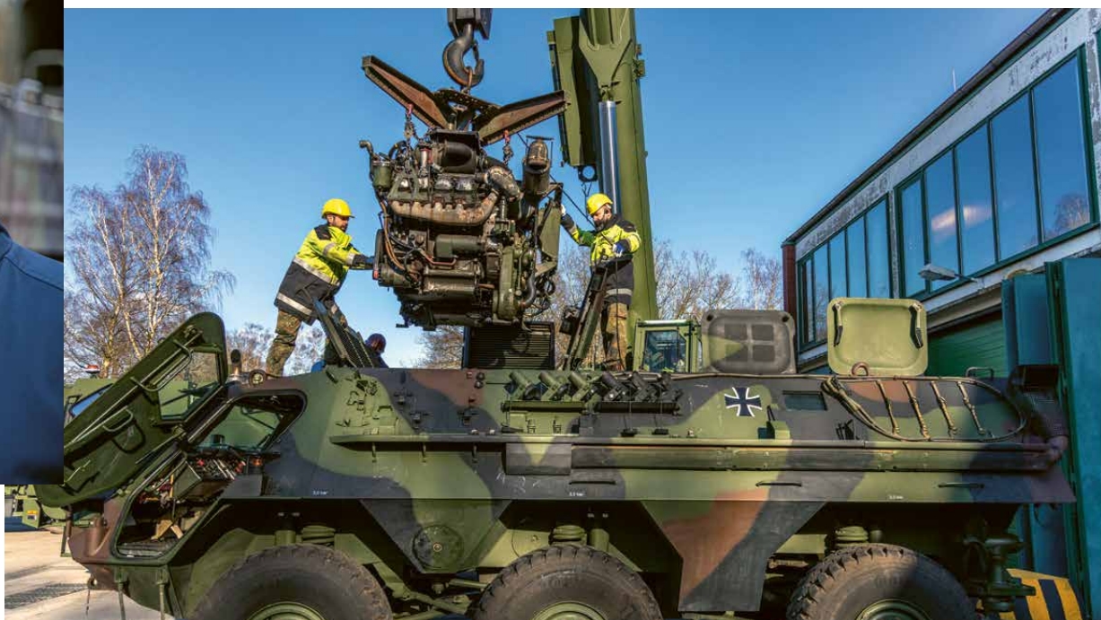
Fahrzeuge müssen der Truppe schnell wieder zur Verfügung stehen. Deshalb werden zum Beispiel beschädigte Antriebsaggregate als komplette Einheit getauscht. Nach 30 Minuten ist das Fahrzeug wieder einsatzbereit.
