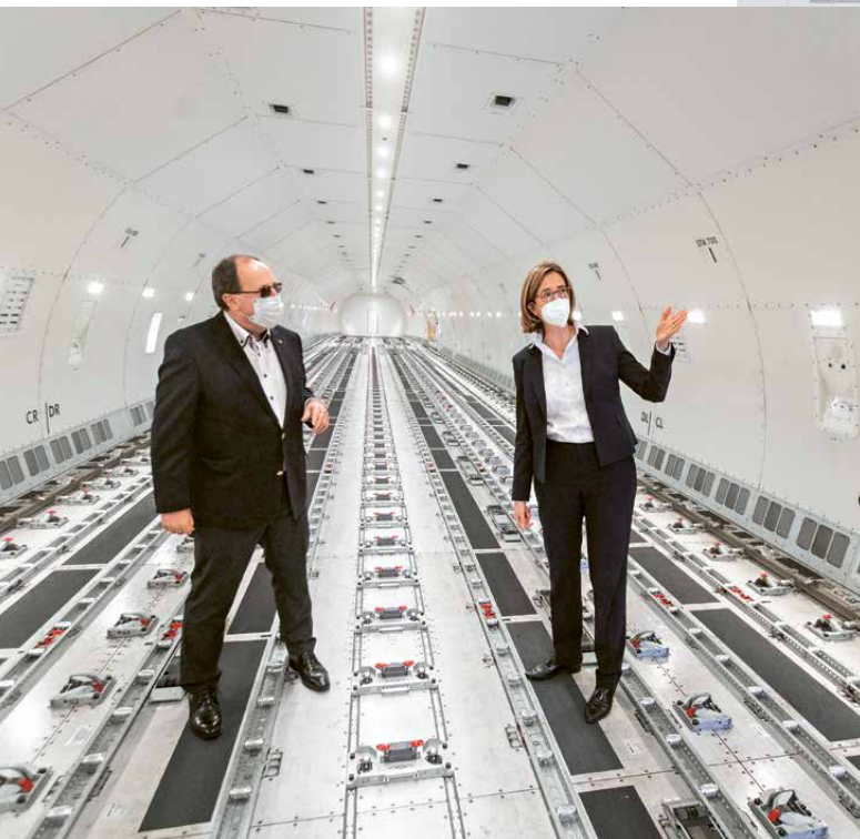
Spaziergang durch den gut 60 Meter langen Frachtraum: Die Boeing 777F hat eine Ladekapazität von 653 Kubikmetern und fliegt mit einer maximalen Zuladung von 103 Tonnen.
