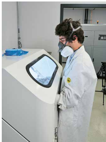
Das selektive Lasersintern ist eine 3-D-Druck-Methode, die Continental für Kunststoff-Zubehörtteile nutzt.
