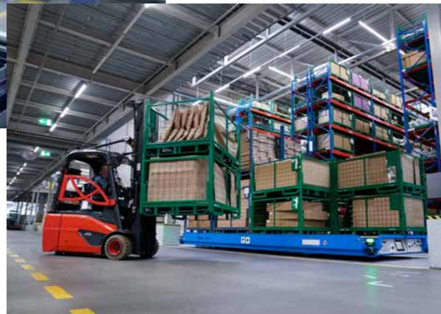
Die „AutoBox“ eignet sich ideal für den Transport über weite Strecken im Werk. Hier wird sie manuell durch einen Staplerfahrer beladen.
