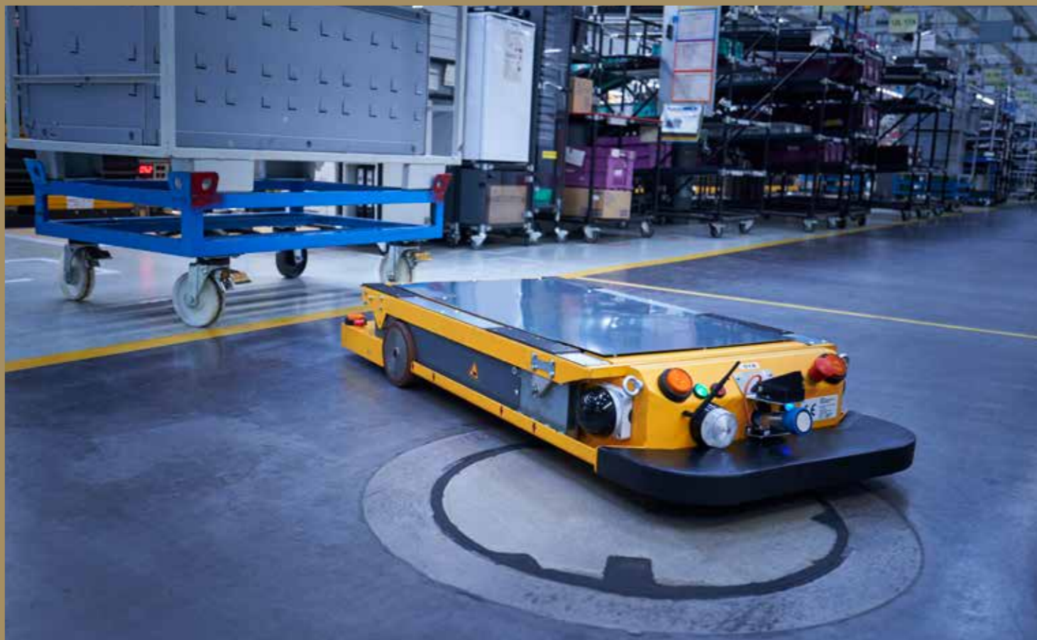
Die fahrerlosen Transportsysteme sind in der Lage, Hindernisse zu erkennen und eigenständig zu umfahren.
