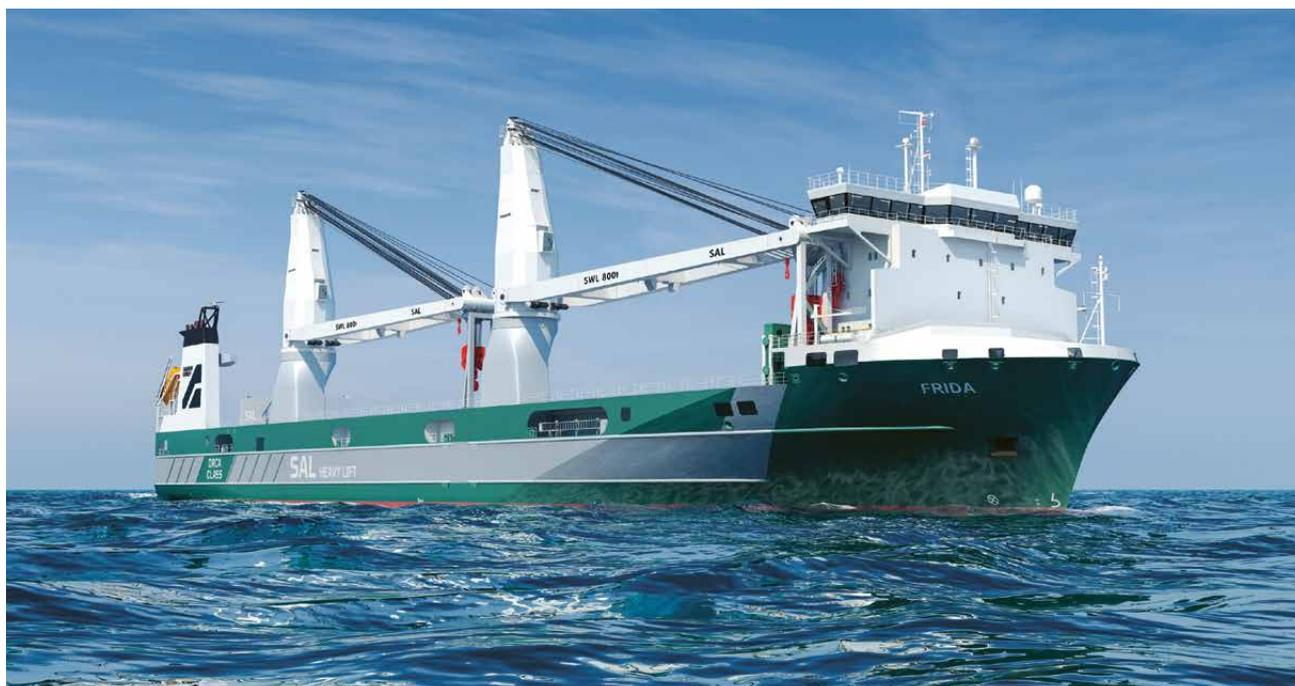
Die Schiffe der Orca-Klasse sind moderne Schwergutschiffe mit Hybridantrieb. Sie bieten eine große Ladekapazität sowie elektrische Krane mit bis zu 1.600 Tonnen Hebekraft – und erfüllen höchste Umweltstandards mit potenziell CO<sub>2</sub>-neutralem Betrieb.
