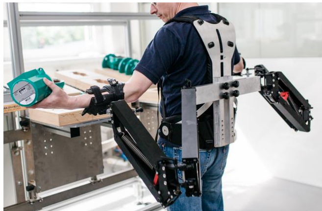
Abbildung 5: Prototyp des Exoskelett-Arm-Moduls Robo-Mate (Robo-Mate 2016b)
