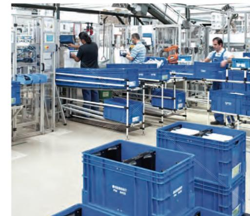
Pullgesteuerte Fließfertigung eines Spülkastens
