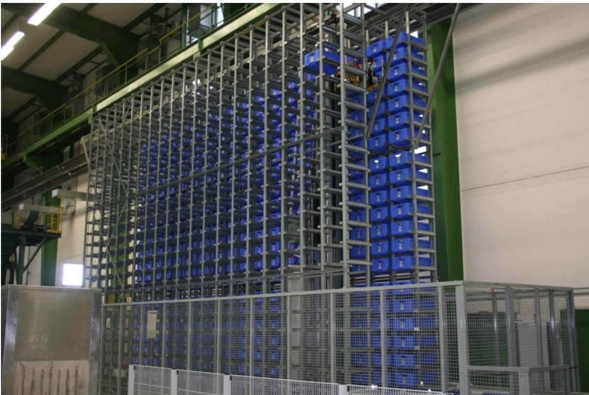
Abbildung 10: Das Automatische Kleinteilelager am Institut für Logistik und Materialflusstechnik an der Otto-von-Guericke-Universität Magdeburg [SMZ12b, S. 71]
